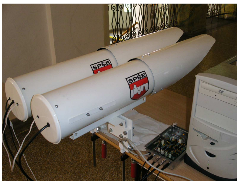
Obr. 3 – RONJA při testování na chodbě SPŠE
