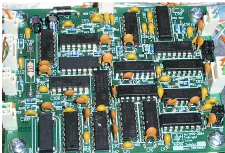
Obr 4. – Osazený plošný spoj rozhraní
