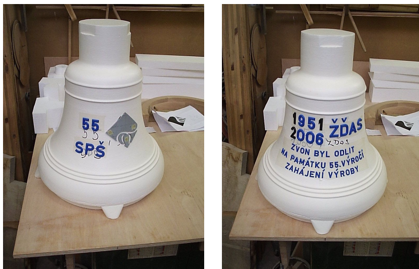
Obrázek 8 Polystyrénový model zvonu
