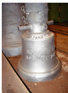
Zvon s nálitkem, bez vtokové soustavy
