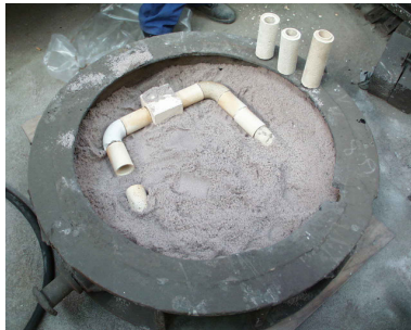
Založení vtokové soustavy
