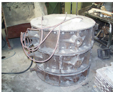
Vytvrzování pomocí CO 2
