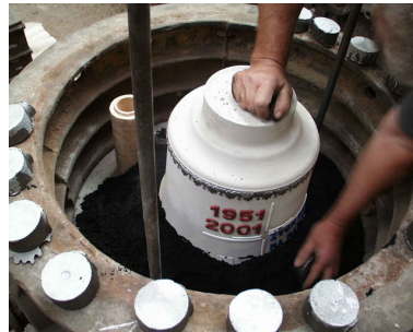
Zasypávání chromitovým pískem
