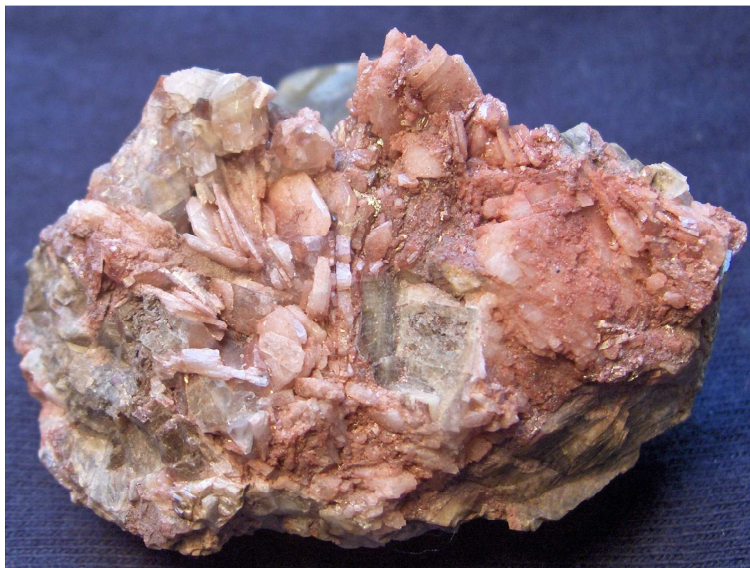
Foto č.26- Tabulkovité krystaly barytu z dutiny hydrotermální žíly. Lokalita Dřínová, 6 cm.
