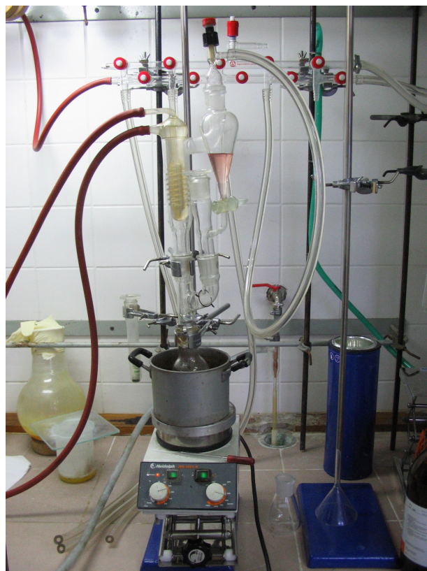
Obr. 6-8: Refluxní aparatura při druhém pokusu o polymeraci
