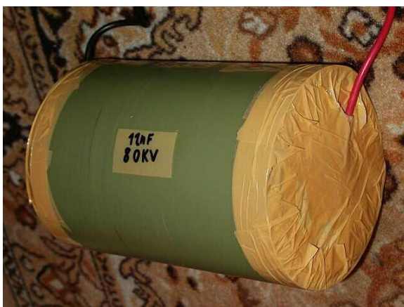
Obr. 13: Kondenzátor vyráběný z linolea
