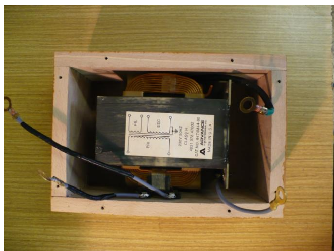
Obr. 20: Napájecí transformátor M.O.T. 2
