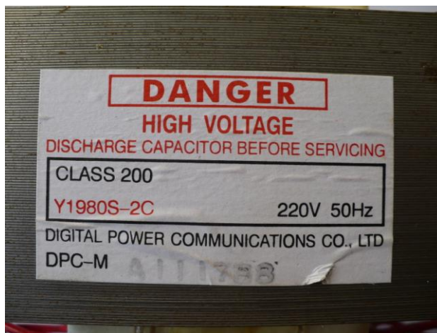
Obr. 18: Detail štítiku na napájecím transformátoru M.O.T.1
