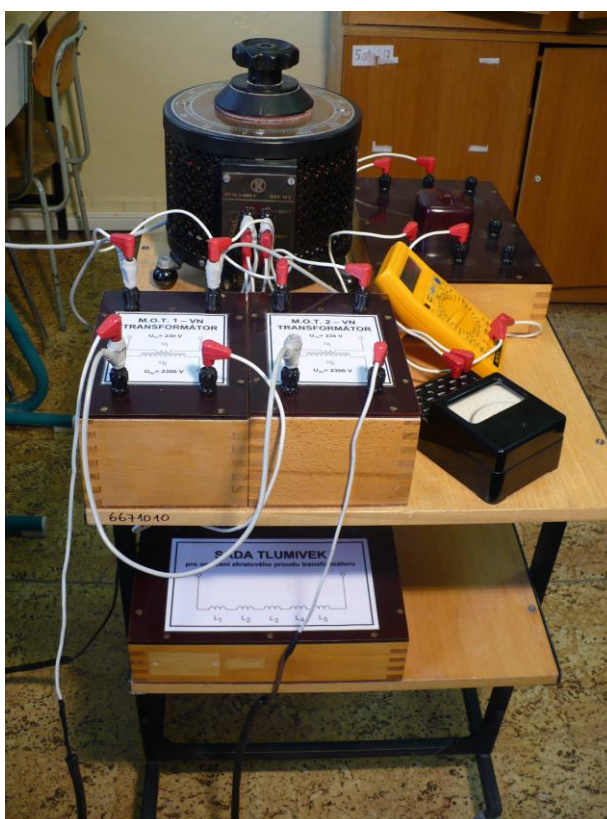
Obr. 43: Řídící část – autotransformátor, spínač, MOT1 a2, sada tlumivek, měřící přístroje
