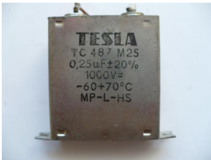
Obr. 38: Použitý kondenzátor TESLA TC 487 M25 0,25µF
