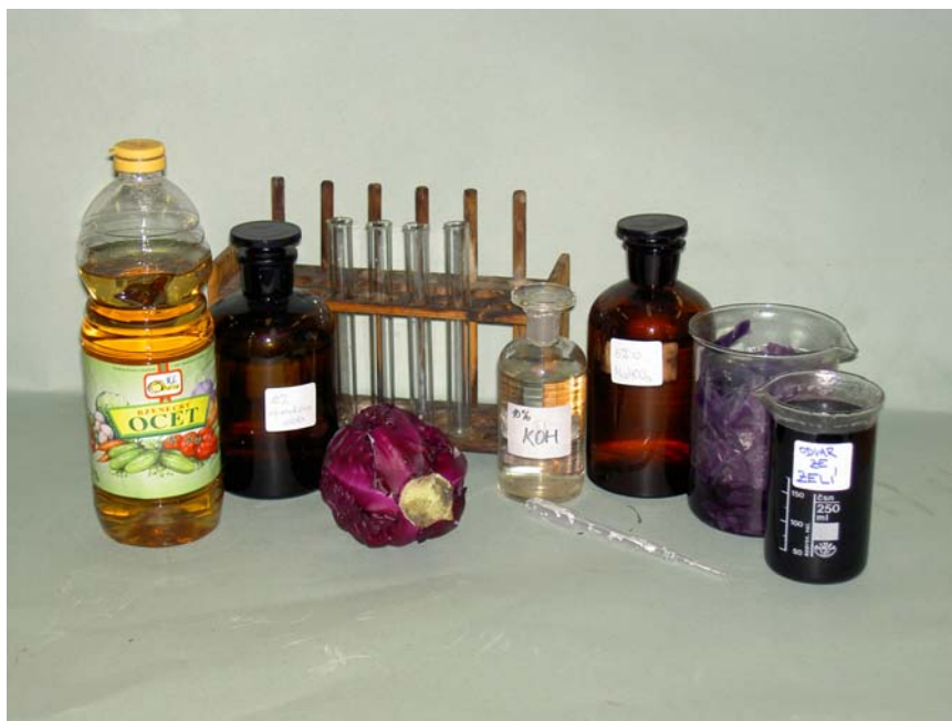
Obr.10: Pomůcky a chemikálie k experimentu „přírodní indikátor kyselosti“
