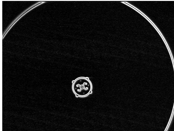
Obr. 52. Detekce hran Sobelovým filtrem
