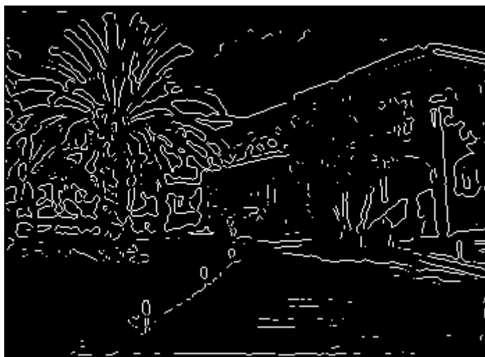
Obr. 24. Detekce hran LoG operátorem, \sigma=2
