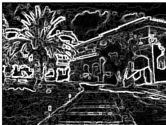
Obr. 46. Detekce hran Sobelovým filtrem
