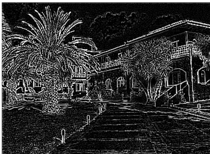
Obr. 23. Detekce hran Laplaceovým filtrem
