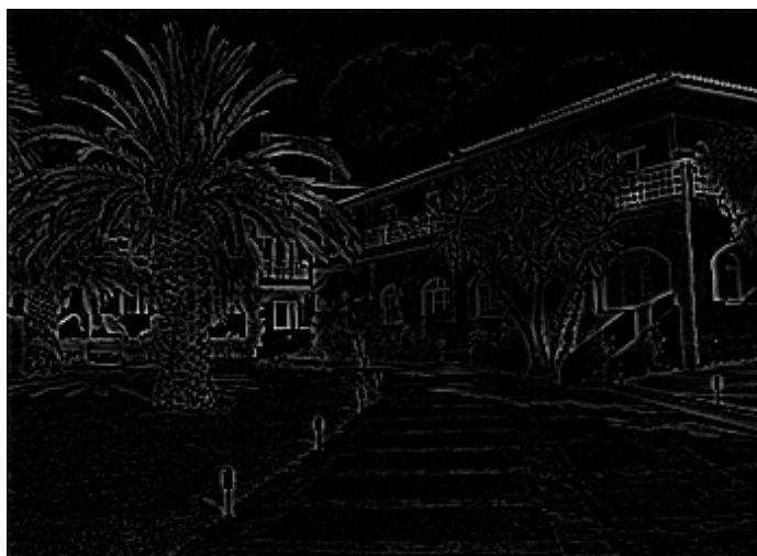
Obr. 25. Detekce hran DoG operátorem, \sigma_1=1 , \sigma_2=2,5
