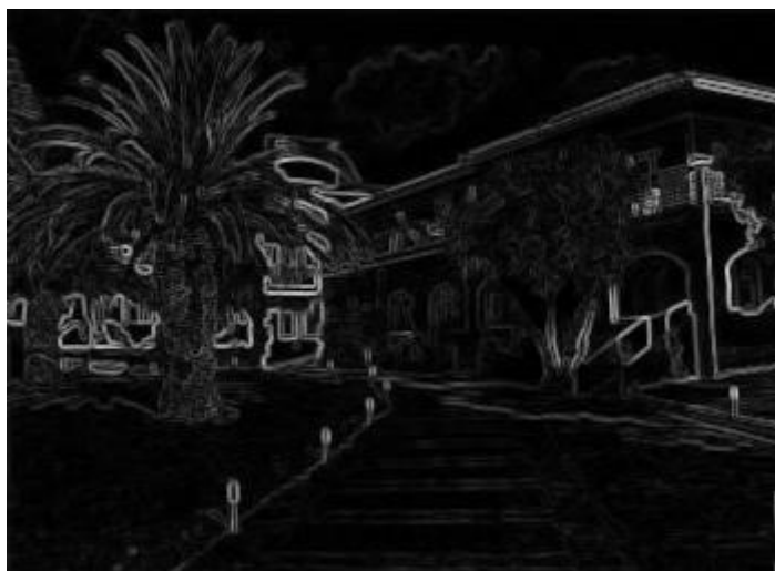
Obr. 22. Detekce hran Kirschovým filtrem
