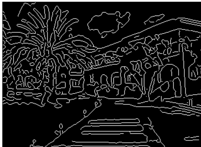
Obr. 27. Detekce hran Cannyho detektorem, \sigma=1,35 , T_1=20 , T_2=100
