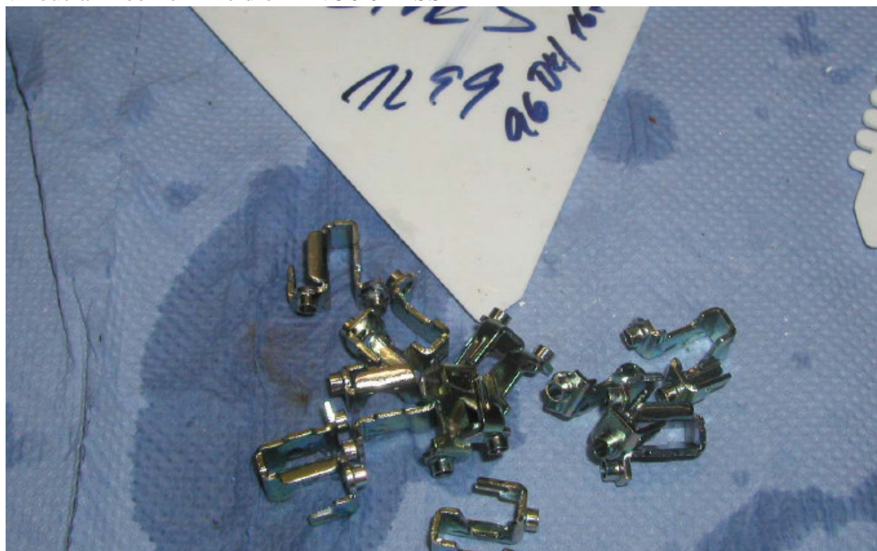
Fotografie dílů Brush holder P 70 – závěsové zinkování po 168 hodinách zkoušky v neutrální solné mlze dle DIN 50 021 SS
