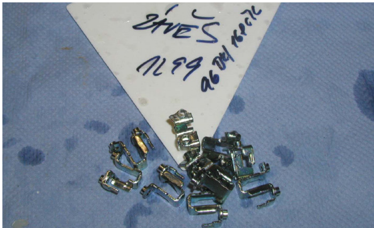
Fotografie dílů Brush holder P 70 – závěsové zinkování po 96 hodinách zkoušky v neutrální solné mlze dle DIN 50 021 SS
