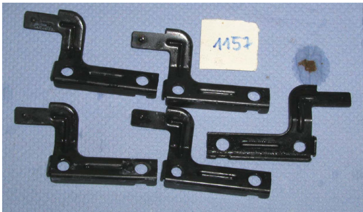
Fotografie dílů Halter 569811 – 3800 po 360 hodinách expozice v neutrální solné mlze dle DIN 50 021 SS
