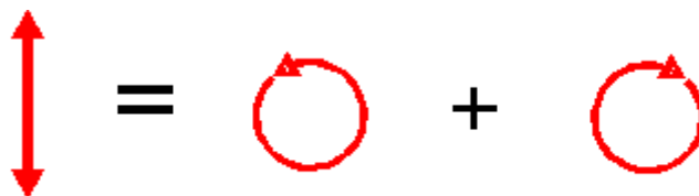
Obr. 5 – superpozicí dvou cirkulárně polarizovaných světelných svazků vznikne lineárně polarizované světlo ([9])
