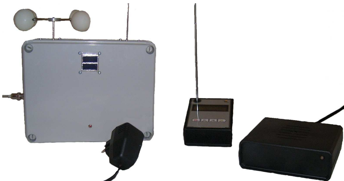
Obr. 43 – Všechny části meteostanice (zleva: Modul snímačů, Zdroj modulu záznamů, Modul záznamů a zdroj pro dobíjení modulu snímačů)
