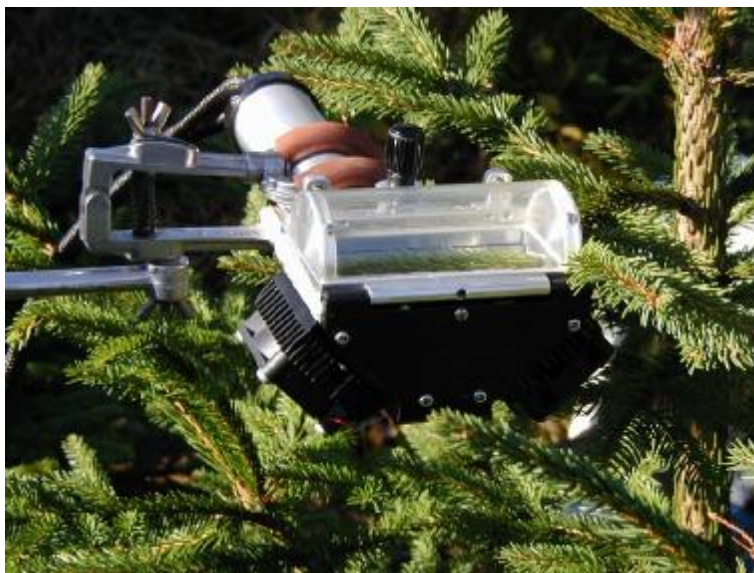
Obr. 5.9: Asimilační komora na měření rychlosti fotosyntézy
