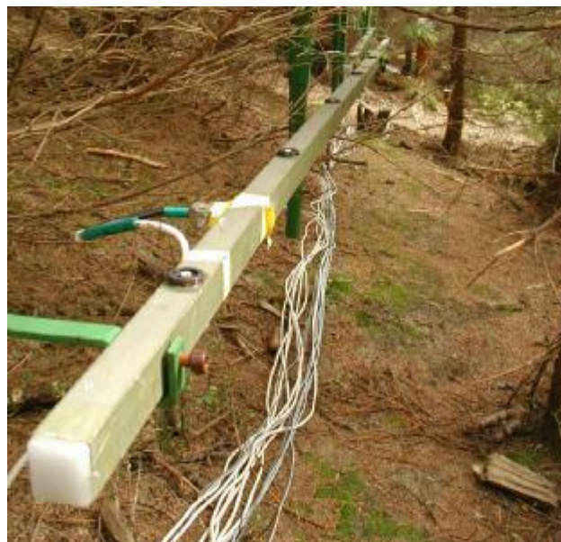
Obr. 5.5: Sestava čidel pro měření FAR pronikající pod korunovou vrstvou smrkového porostu Na EEP Bílý Kříž.
