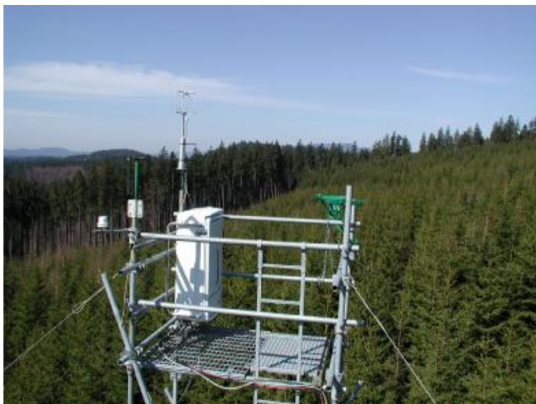
Obr. 5.7: Eddy kovarianční systém umístěný nad smrkovým porostem na EEP Bílý Kříž
