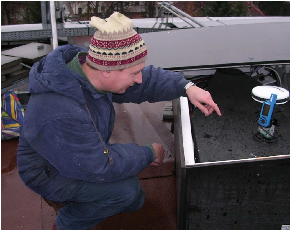
foto 6 – diferenciální GPS stanice a její obslužný pracovník
